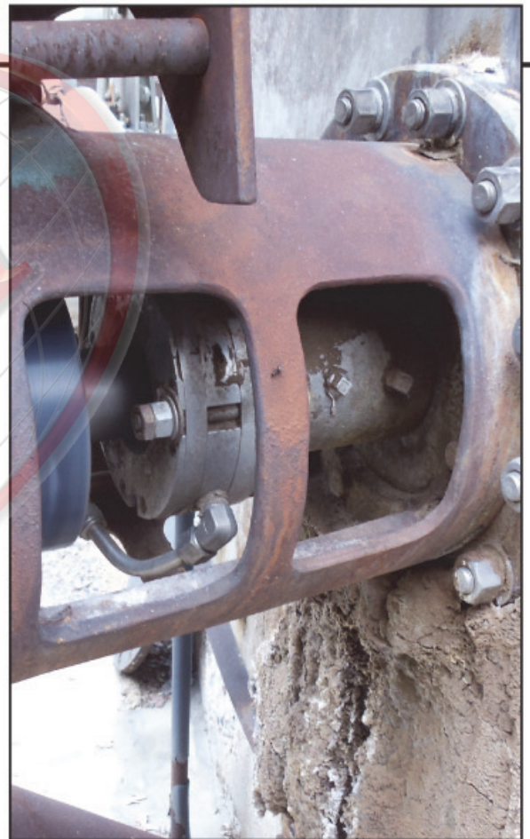
安装在侧面进料型搅拌器上的不锈钢 Air Mizer 密封产品可避免产品的浪费与污染。
